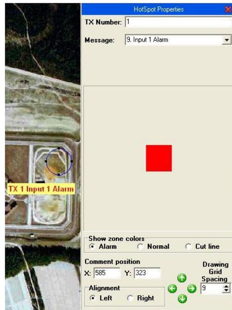
7.4.2.3. **SET HOTSPOT SENSOR IMAGE/SET HOTSPOT FENCE IMAGE/SET HOTSPOT TAMPER /SET HOTSPOT BATTERY**
