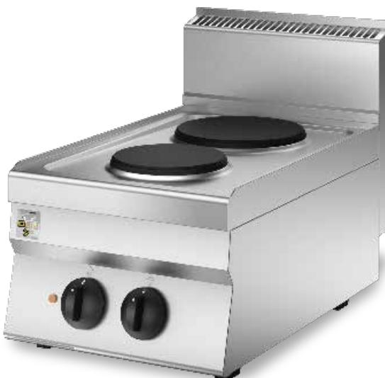
I piani di cottura elettrici sono disponibili con 2 o 4 piastre rotonde in ghisa in versione standard o potenziata. Le piastre sono fissate ermeticamente al piano che ha un invaso per la raccolta dei liquidi ed è completamente liscio per una più facile pulizia. La temperatura viene regolata per mezzo di un selettori a 7 posizioni e sul cruscotto è posta la spia che segnala l'attivazione del riscaldamento. Un termostato limita accidentali temperature eccessive.
