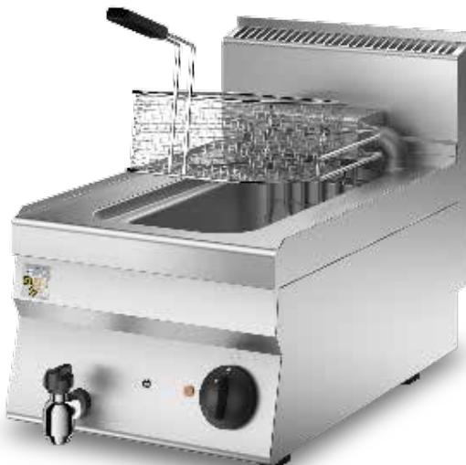
Le friggitrici hanno vasche stampate con fondo inclinato per favorire lo scarico dell'olio. La versione elettrica è disponibile con potenza da 6 kW o 9 kW cada vasca. Le resistenze sono completamente estraibili dalla vasca per consentire una ottimale pulizia della stessa. Controllo termostatico della temperatura regolabile da 100 a 190°C, termostato di sicurezza e spie luminose per segnalare l'attività di riscaldamento
