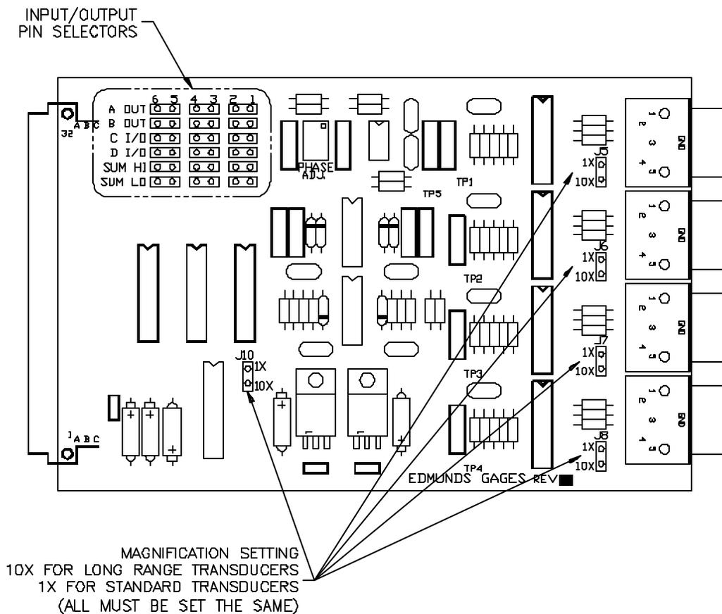
Figure 4.4 - LVDT Module E9310 or E9320
