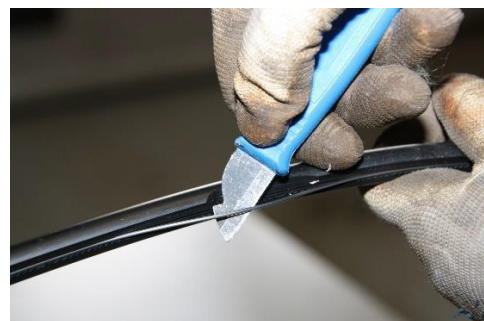
Kaiva teräslangat esille.
