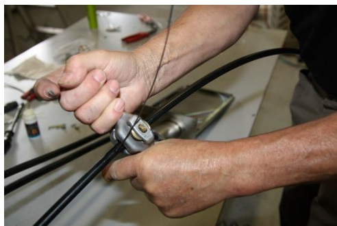
Halkaise vaippa teräslankojen urista käyttäen ST-OCS -vaippakuorijaa.
