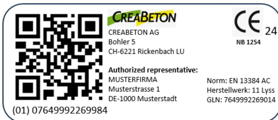
Abbildung 3: Mögliche Darstellung einer Kennzeichnung mit den geforderten DPP-Bausteinen.
